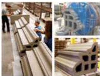
وهو الأكثر شيوعاً في انتاج التراكوتا وينقسم إلى نوعين التشكيل بالبتق (extrusion process) و التشكيل بالضغط اللدن (Press RAM) ويتميز بجودة القطع المنتجة بهذه الطريقة وسرعة معدل الإنتاج مقارنة بالإنتاج بالصب.
