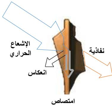
شكل (15) قطاع جانبي يوضح الأداء الحراري لواجهة المبنى المصنوعة من الخزف، حيث عند سقوط الإشعاع الحراري على الواجهة يتم انعكاس جزء منه، و امتصاص جزء آخر خلال خامة الطين ذات السعة الحرارية العالية، و نفاذ الجزء المتبقي الي الداخل.
